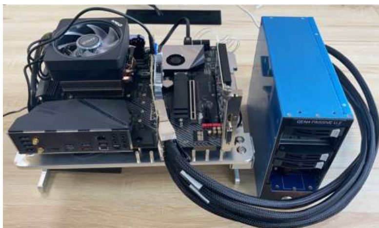
图 5-33 Passive 盘柜连接方式（使用特殊定制线缆）
