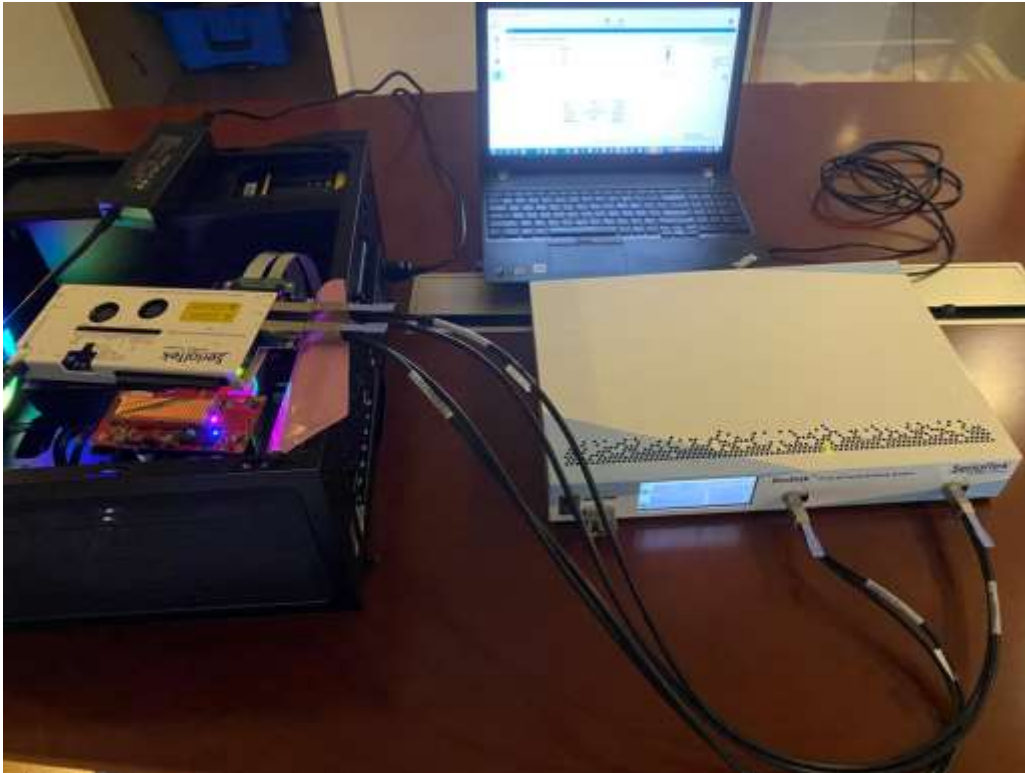
图 2-40 Slot interposer 协议分析仪连接实拍图（带延长线）
