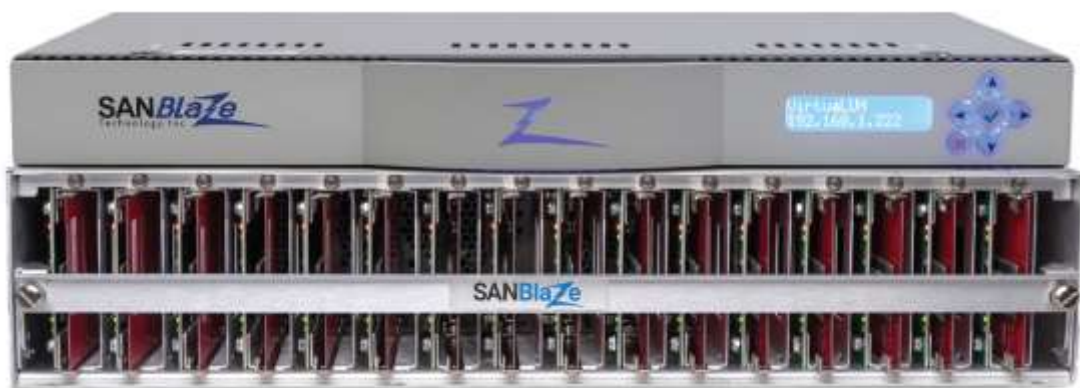
图 3-5 SanBlaze 机架式 RM (Rack Mounted) 测试主机和盘柜实拍图 (支持 16 个 Gen 4 U.2 SSD)
