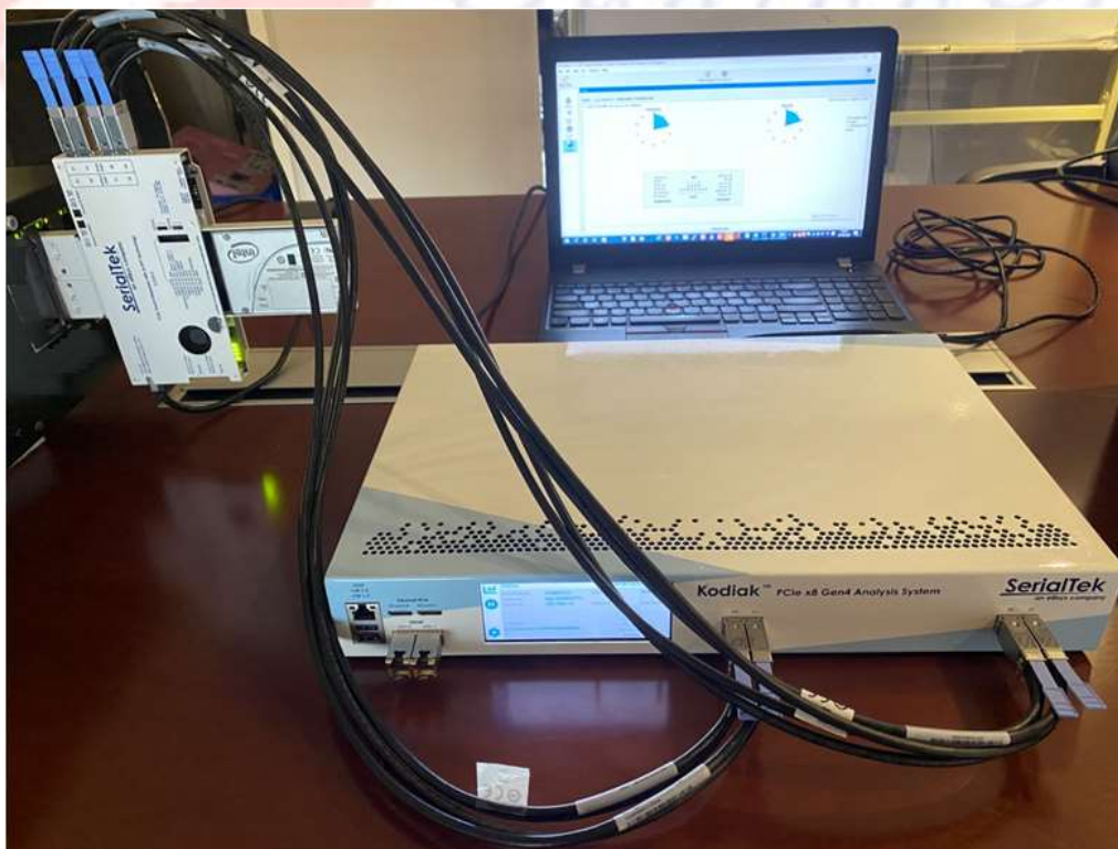
图 2-34 Gen 4 U.2 NVMe SSD 协议分析仪连接实拍图
