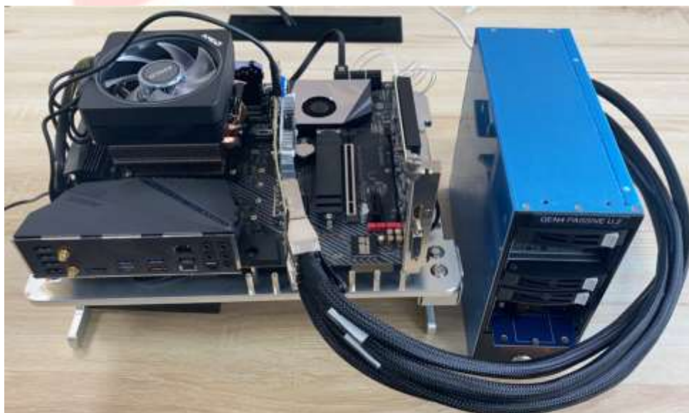
图 6-167 Passive 盘柜连接方式（使用特殊定制线缆）
