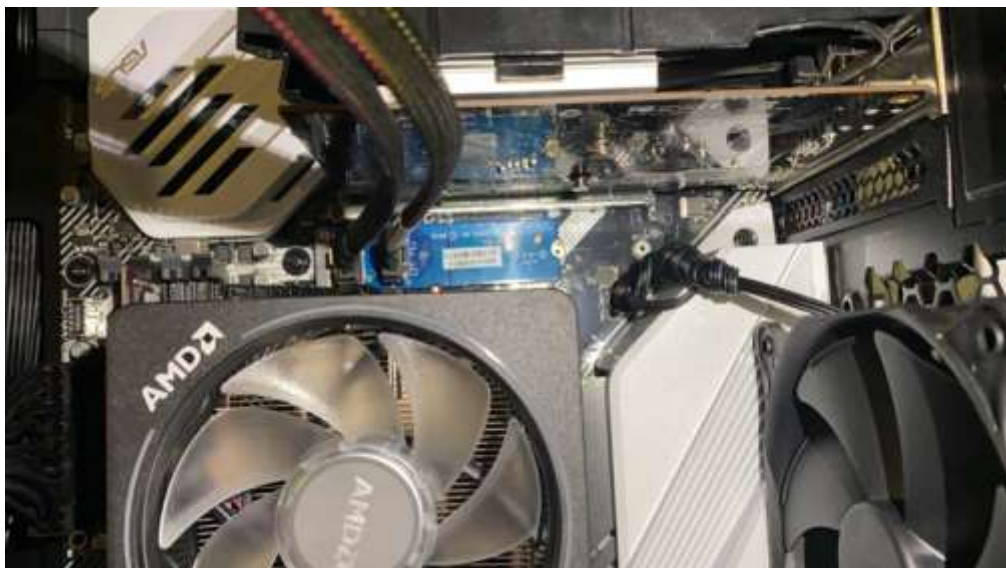
图 2-38 M.2 interposer 的 Host Adapter 细部连接实拍图
