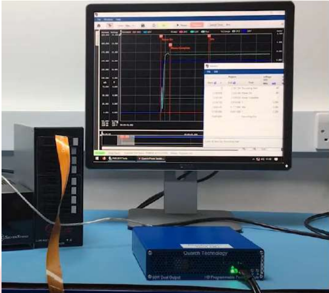
图 4-58 可编程电源，管理软件和转接线缆
