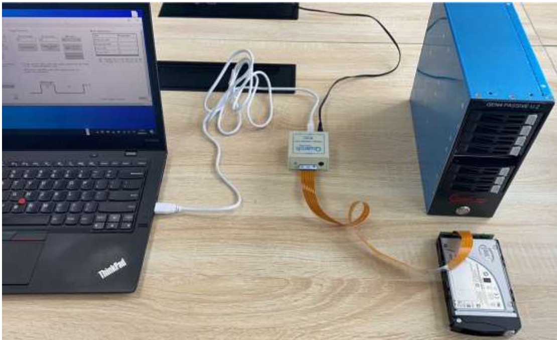
图 4-8 最精简配置 Gen 4 U.2 NVMe SSD 热插拔模块连接图实拍
