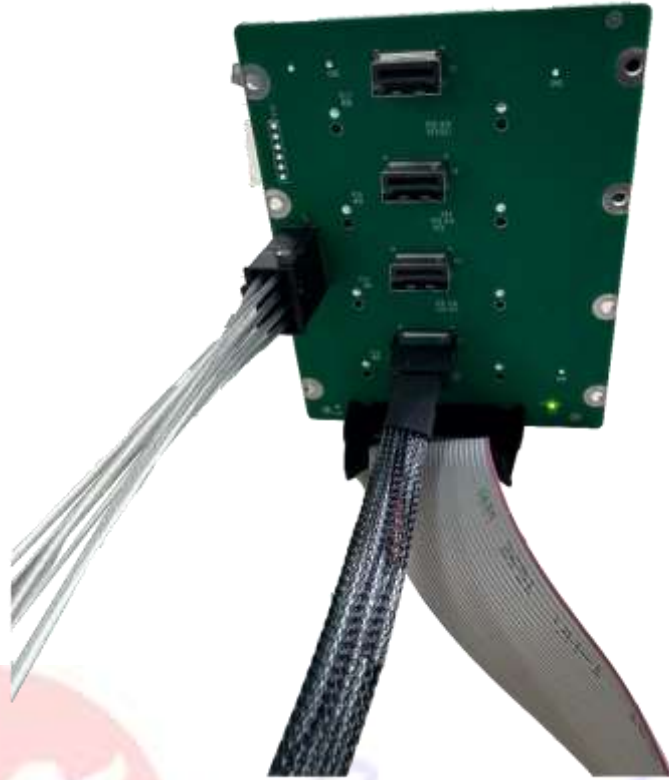
图 8: PCIe Gen5 背板的背面 (4 个 M.2 接口连接 Switch 卡)
