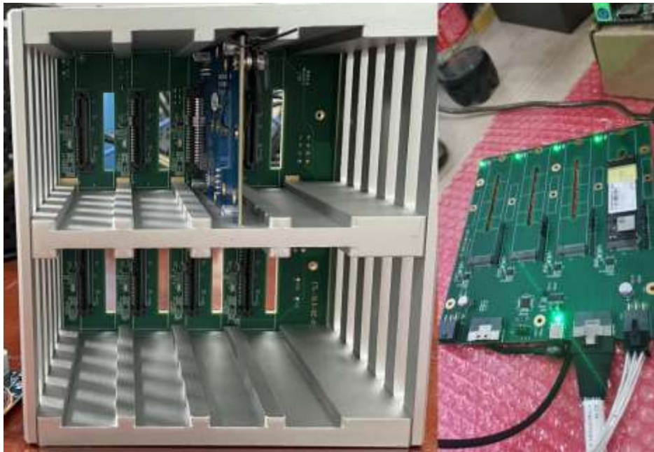
图 6-181 置于高低温箱的 Gen 4 NVMe SSD 背板示意图
