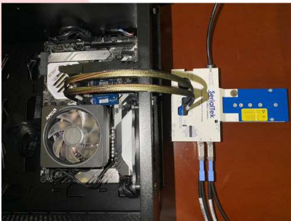
图 2-37 M.2 interposer 细部连接实拍图
