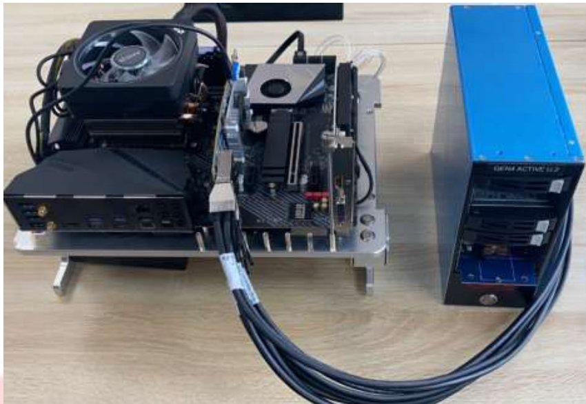
图 5-29 Active 盘柜和 Host Card 的连接方式
