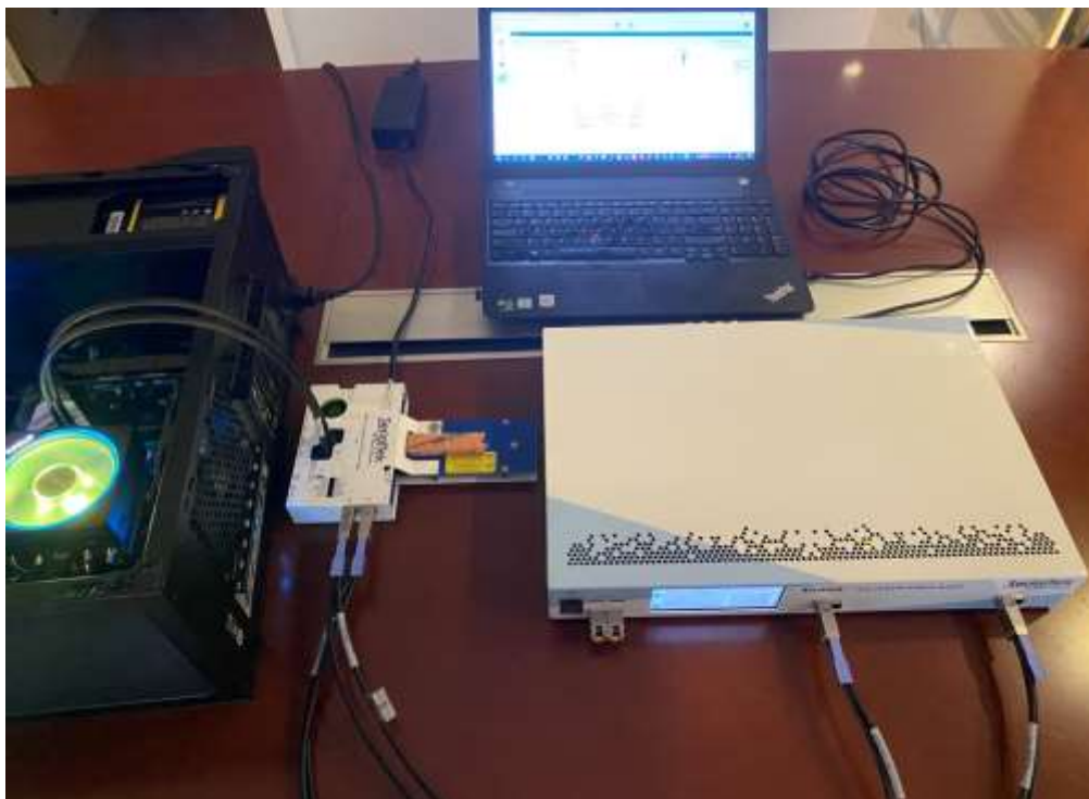
图 2-36 Gen 4 M.2 NVMe SSD 协议分析仪连接实拍图
